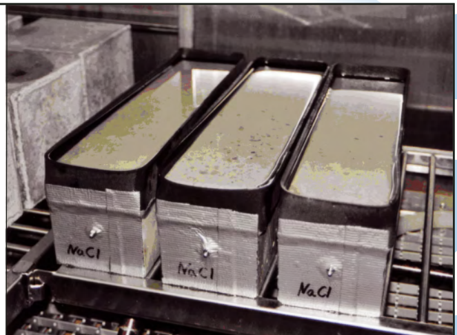
Bild 3: Alkalizufuhr von außen durch Taumittelbeaufschlagung (Probenpräparation analog schwedischem slab-Test)
